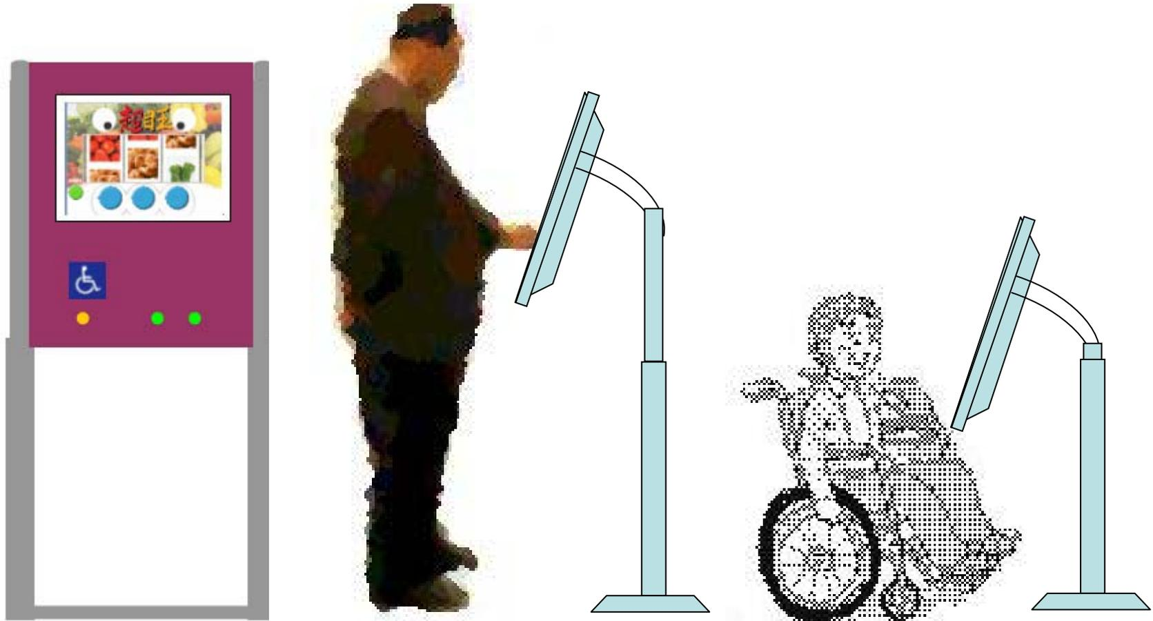
車いすの方、お子様にも対応出来るよう、ボタンを押すとディスプレイ部が下がる仕組みになっています。
