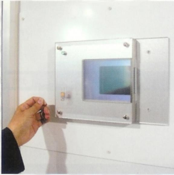
① ICタグが埋め込まれた認証カードを近づけるとシステムが起動し、ディスプレイが表示される。
